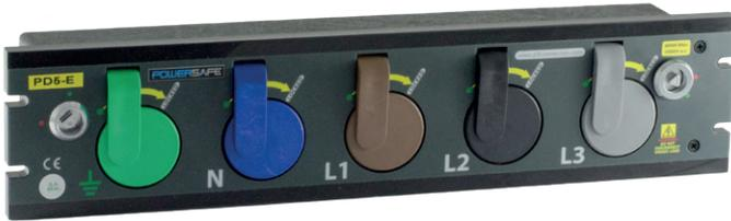
La PowerSAFE Box è un'unità di collegamento a per il generatore o il collegamento alla rete. L'ordine di collegamento e disinserione viene predefinito per assicurare che i circuiti di sicurezza (PE+N) vengano collegati per primi e disinseriti per ultimi. Inoltre i collegamenti codificati impediscono la possibilità di contatti errati.
